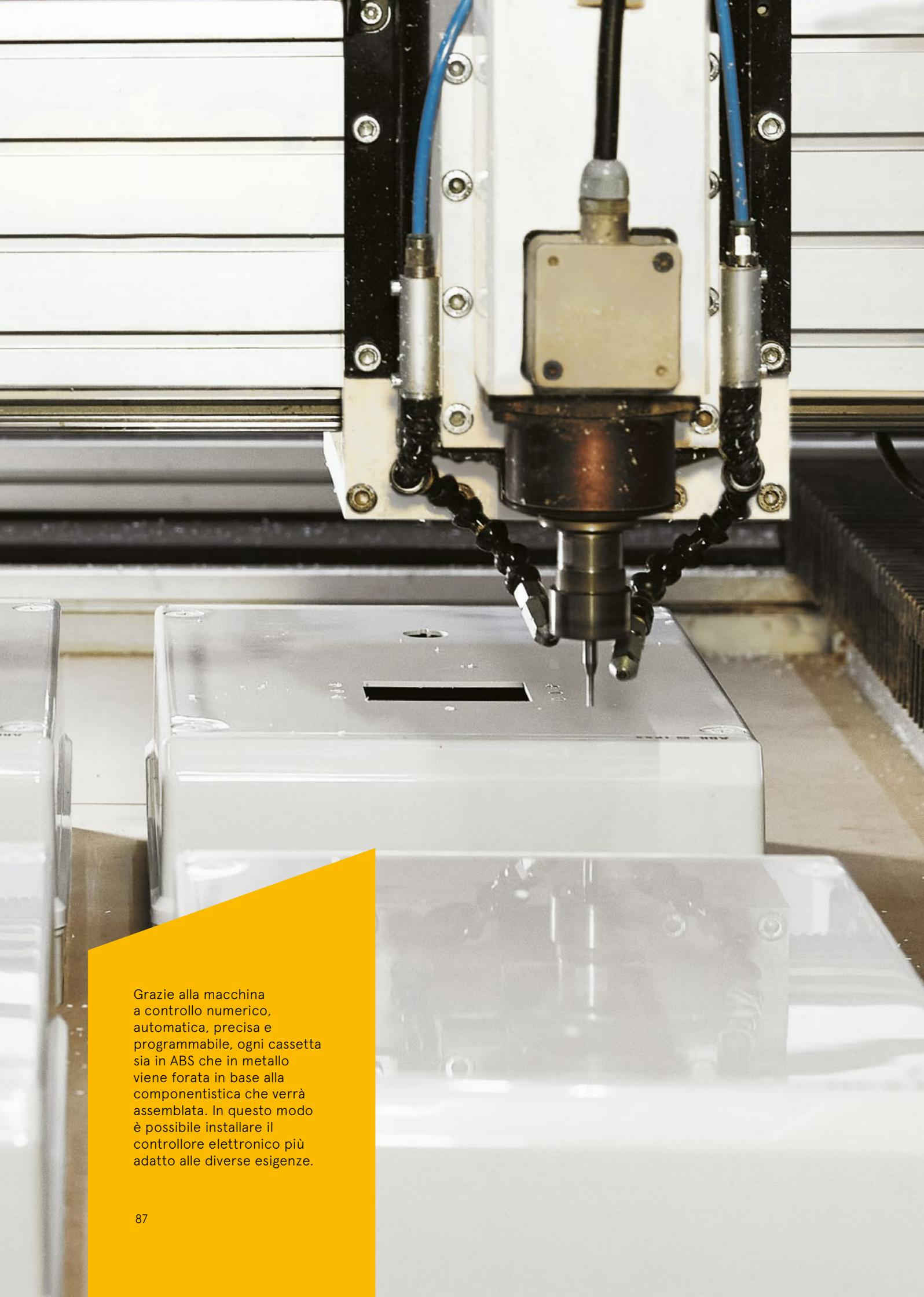
Grazie alla macchina a controllo numerico, automatica, precisa e programmabile, ogni cassetta sia in ABS che in metallo viene forata in base alla componentistica che verrà assemblata. In questo modo è possibile installare il controllore elettronico più adatto alle diverse esigenze.
