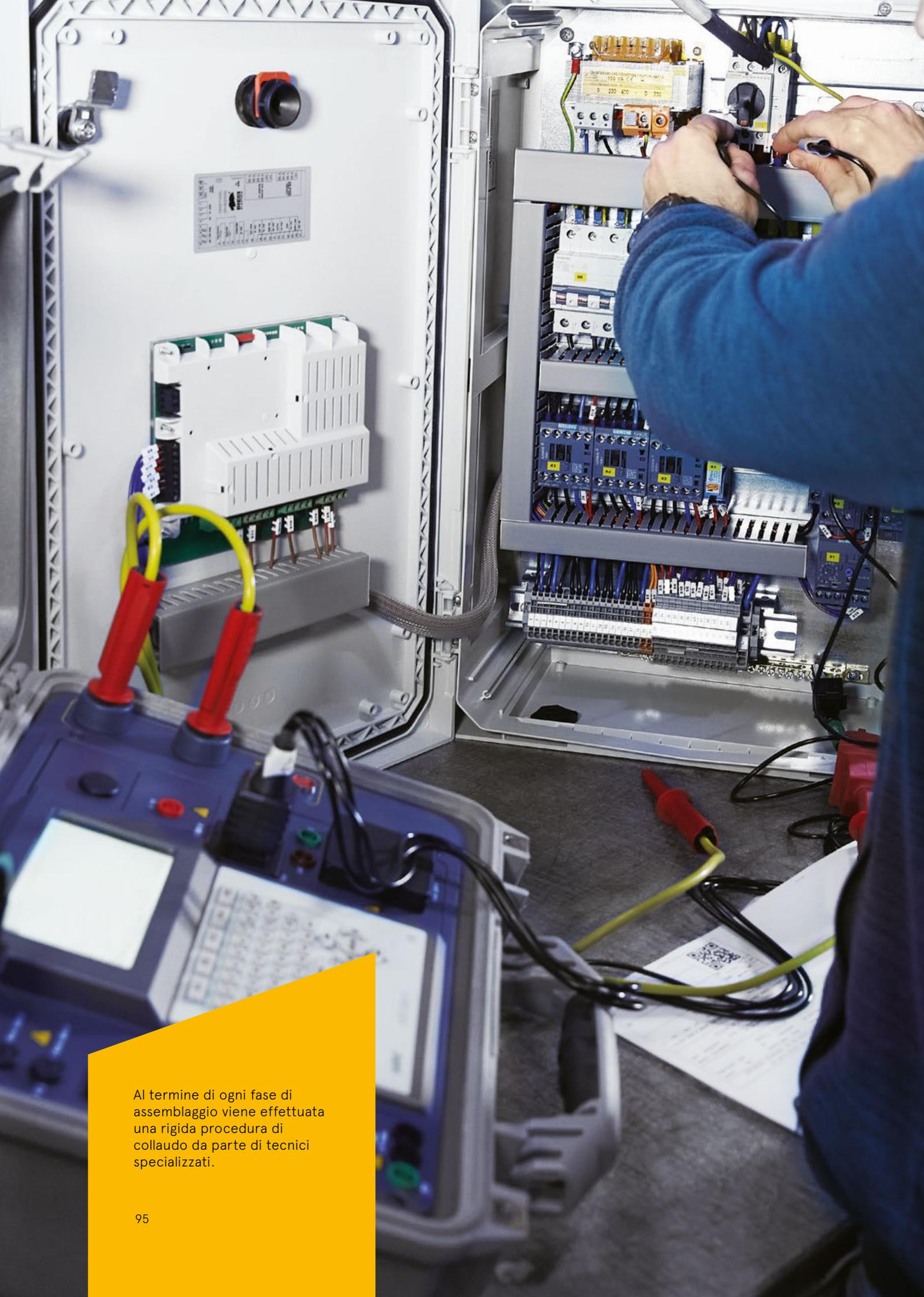
Al termine di ogni fase di assemblaggio viene effettuata una rigida procedura di collaudo da parte di tecnici specializzati.
